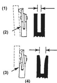
В противном случае, рельса шины изношена. Такая шина должна быть исправлена или заменена.
