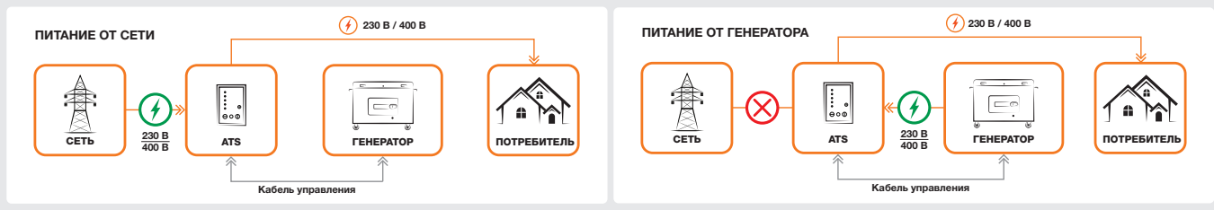
ATS СХЕМА АВТОМАТИЧЕСКОГО УПРАВЛЕНИЯ ГЕНЕРАТОРОМ
