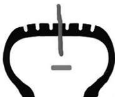
Неправильная установка жгута
