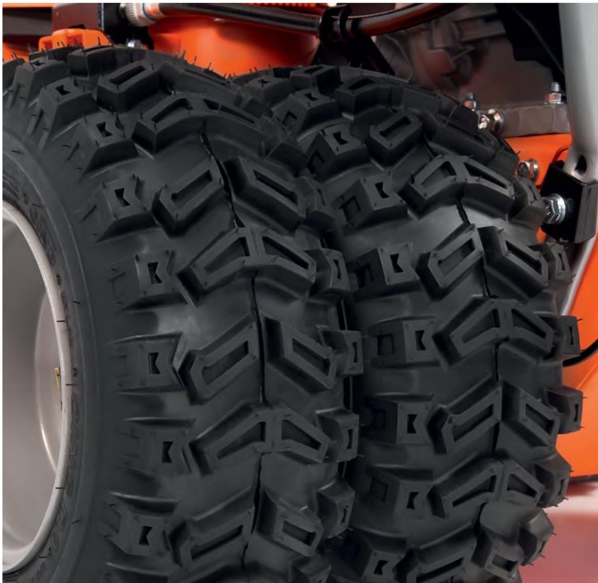
Новые колеса увеличенного диаметра **41 см** с протектором специальной формы **X-TRACK** с увеличенным пятном контакта еще лучше обеспечивает наилучшее сцепление с зимней и обледенелой поверхностью.
