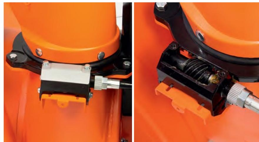
Механизм собирается и тестируется на заводе с нанесением заводской смазки и надежно защищен от повреждений и попадания влаги.
