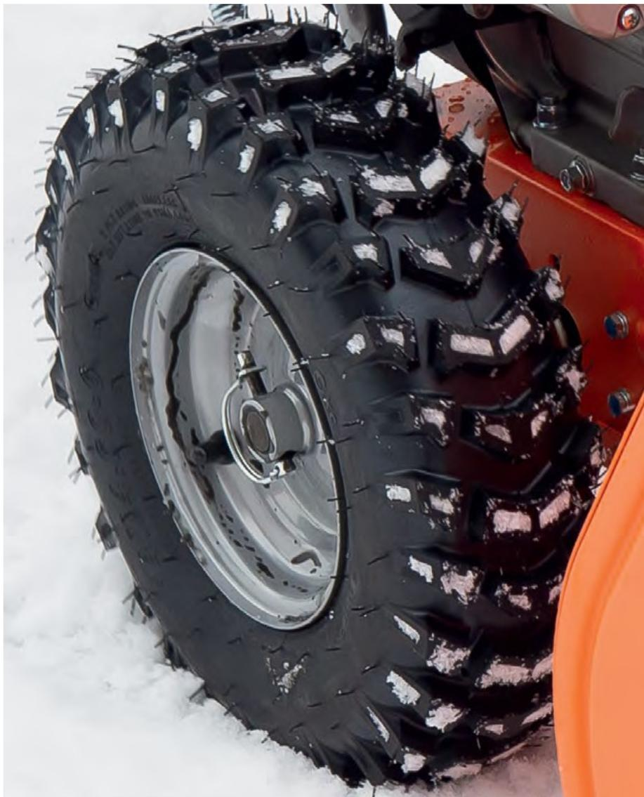
Протектор специальной формы X-TRACK с увеличенным пятном контакта обеспечивает наилучшее сцепление с обледенелой поверхностью.
