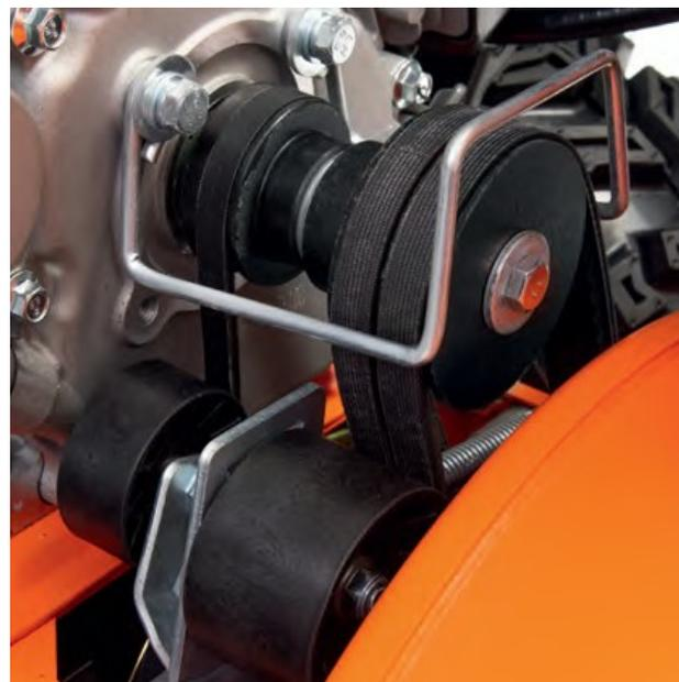
Два клиновых ремня привода шнеков обеспечивают надежность и высокую производительность, исключают проскальзывание шнека при уборке плотного снега. За привод движения отвечает третий отдельный ремень.
