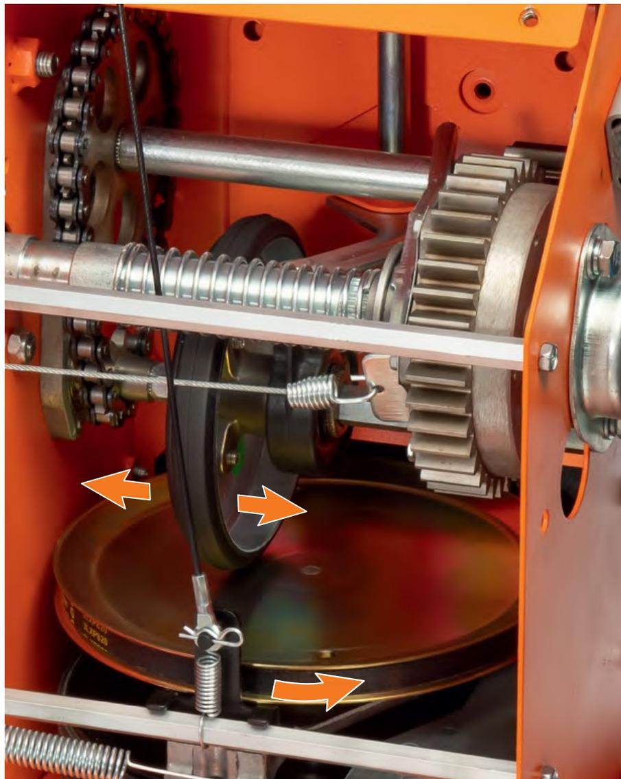
Система обеспечивает передачу крутящего момента без пробуксовки. Переключение передач и изменение скорости движения осуществляется перемещением фрикционного колеса относительно приводного диска.
