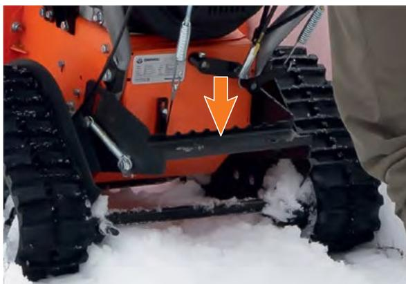
Нажатие на педаль меняет положение центра тяжести. Угол подъема ковша и положение гусеничного привода изменяются в зависимости от поставленной задачи и условий уборки снега.
