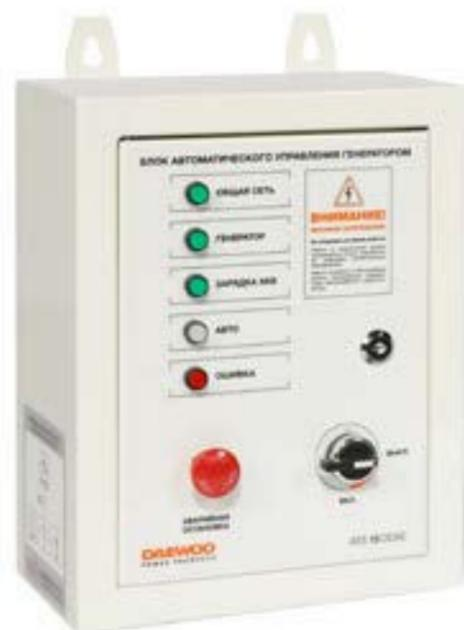
Блок ATS обеспечивает автоматический запуск генератора в случае падения напряжения или прекращения подачи электроэнергии. Блок постоянно контролирует напряжение пускового аккумулятора электростанции и при необходимости заряжает его. Корпус блока выполнен из прочного металла и закрывается на специальный ключ.
