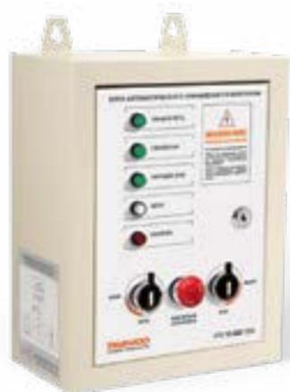
Блок управления генератором обеспечивает автоматический запуск электростанции в случае падения напряжения в основной сети или прекращения подачи электроэнергии. При возобновлении подачи электроэнергии автоматика переводит питание потребителей на внешнюю сеть и отключает генераторную установку. ATS имеет удобное крепление для монтажа на стену.
