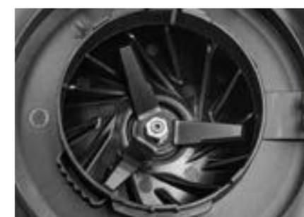
**Двухступенчатая система измельчения**
