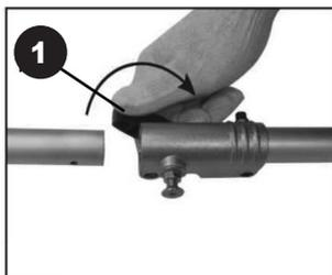
2. Выдвиньте фиксирующий шплинт (2) из соединительной муфты. Вставьте нижнюю часть вала в соединительную муфту, убедившись, что фиксирующий шплинт установился в отверстии на нижнем валу.
