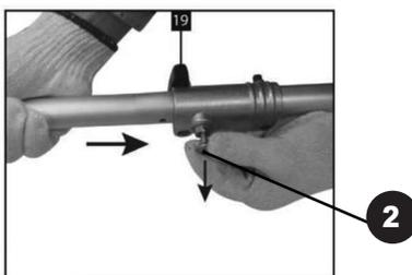
3. Зафиксируйте нижний вал в соединительной муфте затяжкой винтового зажима (3).
