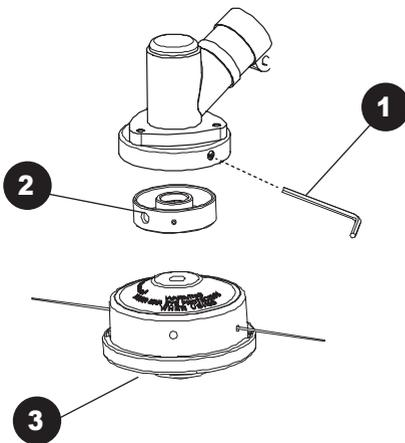
1. Вставьте монтажный штифт (1) через приемную шайбу в выемку конической передачи. Прокрутите вал до попадания штифта в передачу. Приводной вал будет заблокирован.
