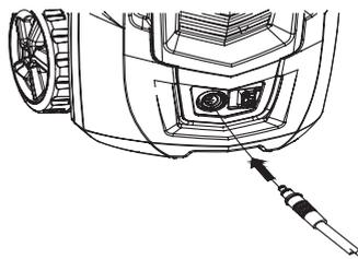
4. Удалите транспортировочную заглушку (если она установлена) со штуцера подвода воды и накрутите на него фильтр. Закрепите шланг подачи воды (не входит в комплектацию). Фильтр должен быть всегда установлен на входном штуцере для предотвращения попадания сторонних частиц, которые могут повредить насос.
