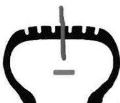
Неправильная установка жгута
